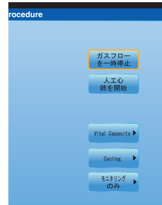
図7. ガスフローを一時停止 気管挿管、気管吸引時など新鮮ガスフローを一時的に停止することで、揮発性麻酔薬による手術室内汚染を軽減することが期待される。
